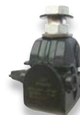
Ce connecteur à perforation d'isolant permet la dérivation du câble aérien de section 6mm<sup>2</sup> à partir d'une torsade réseau de 16 à 95mm<sup>2</sup>.
