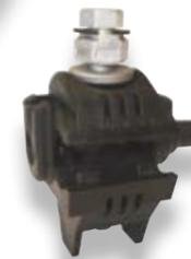
Connecteur de branchement permettant la dérivation de conducteur isolé pour alimenter une habitation. La connexion se fait par perforation d'isolant. De manière générale, les capacités du connecteur sont 16-95/2,5-35mm<sup>2</sup>. Dans certaines applications spécifiques, ces capacités peuvent être 6-95/6-35mm<sup>2</sup>.
