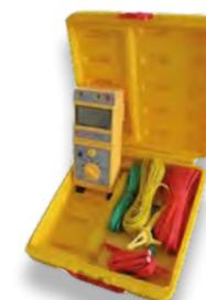
Telluromètre ou mesureur de terre
