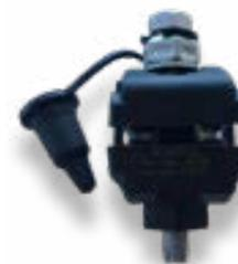
Connecteur de branchement permettant la dérivation de conducteur isolé pour alimenter une habitation. La connexion se fait par perforation d'isolant.
