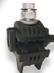
Connecteur de branchement permettant la dérivation de conducteur isolé pour alimenter une habitation. La connexion se fait par perforation d'isolant.
