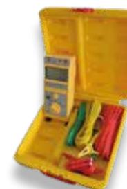
Telluromètre ou mesureur de terre
