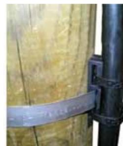
Данный фиксатор используется для крепления кабеля, проложенного вдоль столба или опоры. Аксессуар закрепляется с помощью монтажной ленты. Крепление сделано из термопластичного материала, устойчивого к воздействию УФ излучения. F042 используется для фиксации кабелей или пучков проводов диаметром от 15 до 30 мм, F039 – от 30 до 50 мм, F037 – от 50 до 90 мм.
